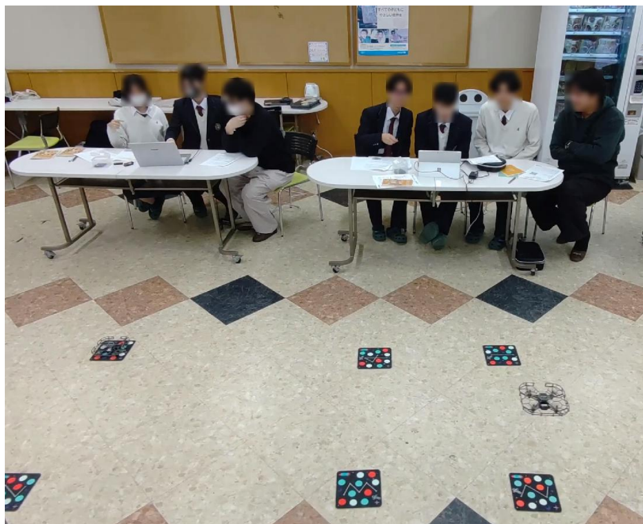
センサーでマーカーを探索しながら自律飛行させる様子（第2回授業）
